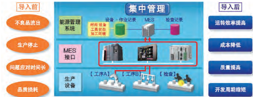
圖6-37 e-F@ctory追蹤方案流程示意圖。資料來源：三菱電機，2015年6月
