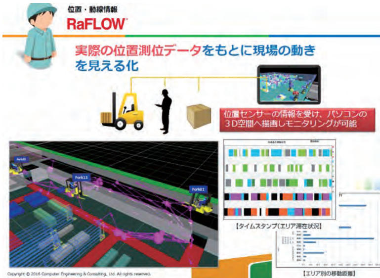
圖6-2 RaFLOW收集與分析作業員位置及動線示意圖。資料來源：株式會社CEC
