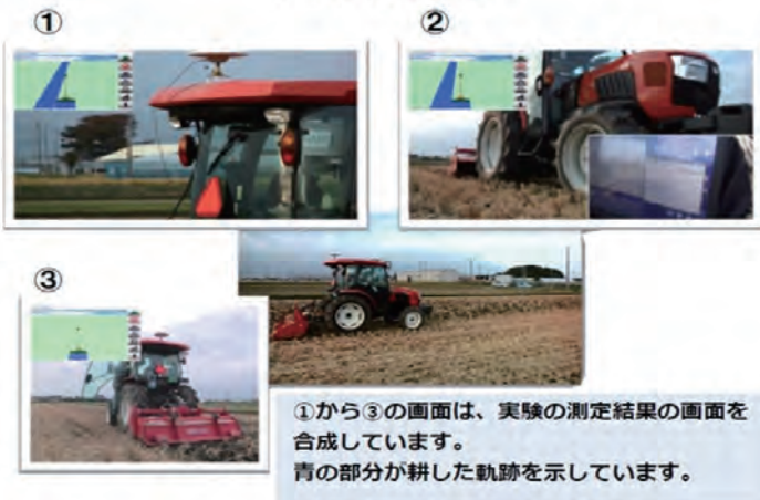
圖6-32 利用準天頂衛星定位系統之農耕機可自動直線駕駛。 資料來源：株式會社CORE
