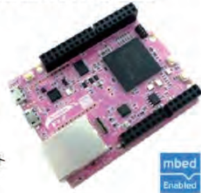
圖6-30 CORE GR-PEACH主機板搭載ARM處理器。資料來源：株式會社CORE
