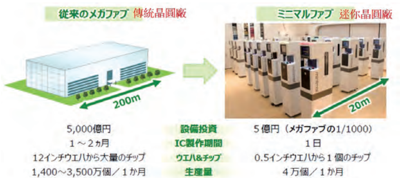
圖6-18 Minimal Fab與傳統晶圓廠比較。資料來源：橫河Solution Service公司
