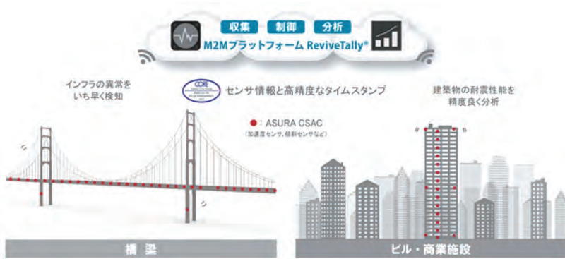
圖6-29 ASURA CSACの原子鐘晶片可用於橋樑與大樓耐震度監控。
