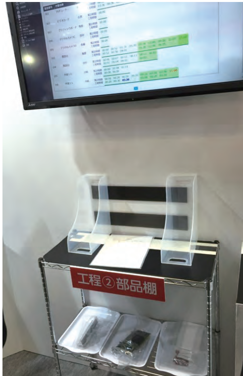
圖6-15 Recopick透過天線薄板感應可記錄物品存取資訊。資料來源：本報告拍攝
