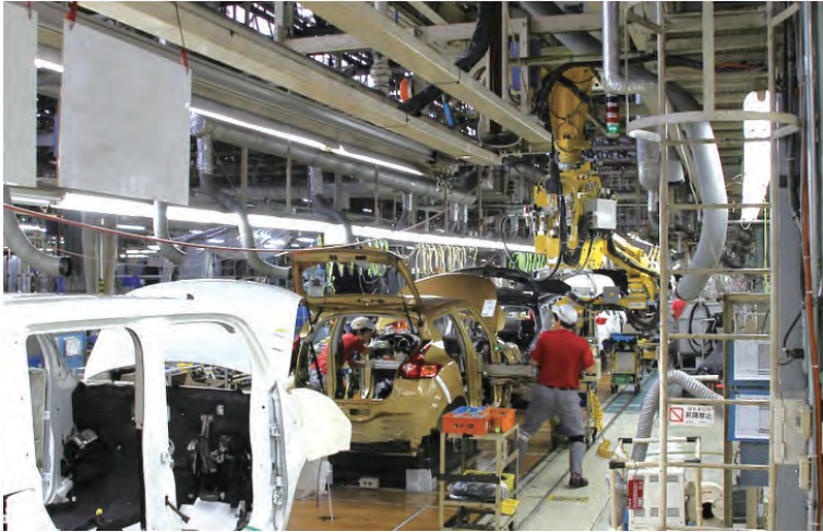
圖6-10 追濱工廠生產線同時組裝不同車款不同顏色車體。資料來源：Car Watch網站
